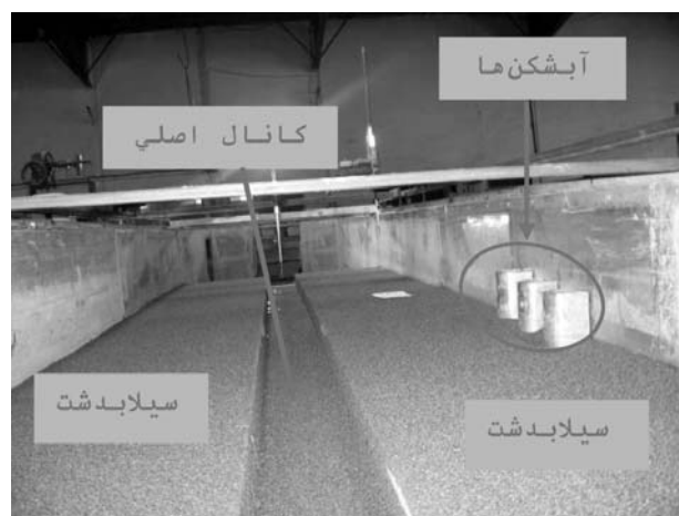
شکل ۵ - نمایی از فلوم و آب‌شکن‌های ۱۰ سانتی‌متر دایره‌ای شکل
