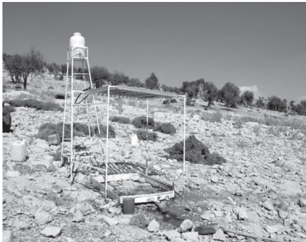
شکل ۲- نمایشی از باران ساز در موقعیت نصب
