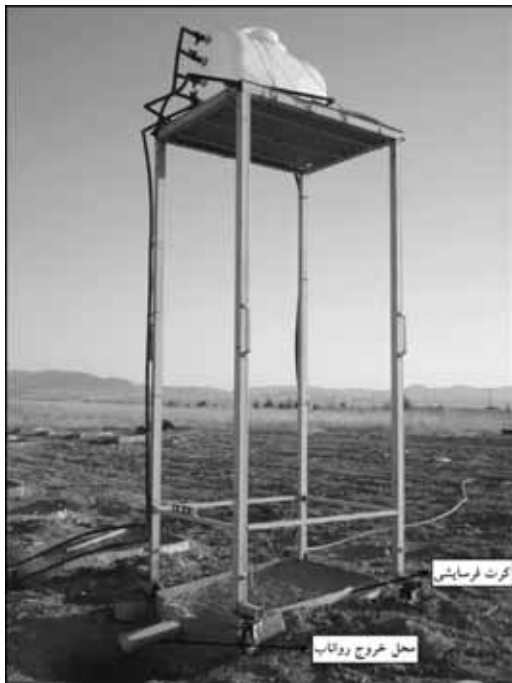
شکل ۳- نمایی از دستگاه شبیه‌ساز باران طراحی شده و کرت فرسایشی مورد استفاده در پژوهش Fig. 3. A view of designed rainfall simulator and erosion plots used in the study
