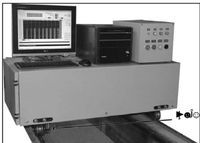
شکل ۲- نمایی از دستگاه برداشت پروفیل بستر لیزری
