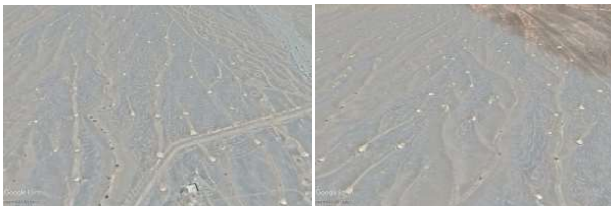
کل ۳- تصاویر هلالی‌های آبگیر اجرا شده در حوضه آبخیز حسین‌آباد
