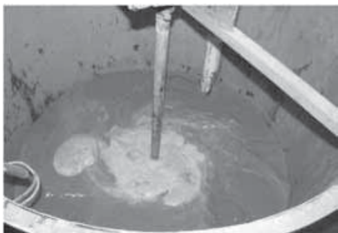
شکل ۸ - نحوه ایجاد رسوب معلق در مخزن اختلاط
