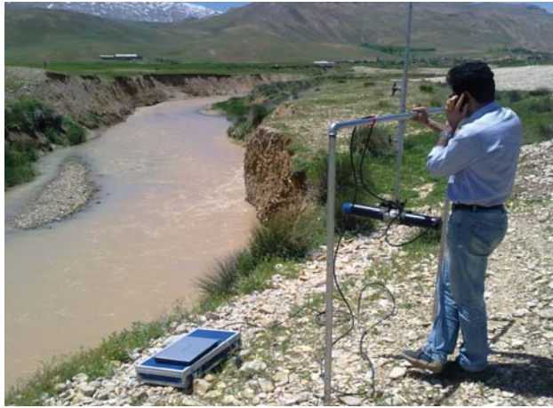
شکل ۳- نمایشی از پلان تجهیزات اندازه گیری سرعت دستگاه Easy Q™ و نحوه استقرار آن در منطقه
