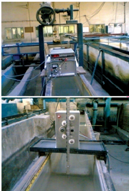
شکل ۲- دستگاه ژرفاسنج و ولت متر استفاده شده برای اندازه گیری تغییرات توپوگرافی بستر
