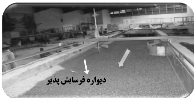
شکل ۱ - نمایی از فلوم و جانمایی آبشکن و تجهیزات مربوطه
