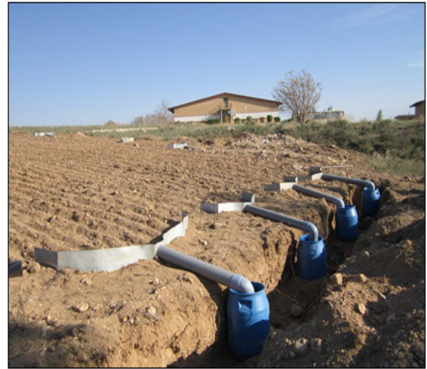
شکل ۱- کرت‌های فرسایشی با طول‌های مختلف در راستای شیب ۱۰ درصد جهت مطالعه هدررفت خاک تحت باران‌های طبیعی Fig 1. Erosion plots with different lengths installed on 10% slope to study soil loss under natural rainfalls
