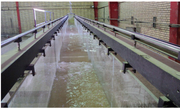
شکل ۲- فلوم آزمایشگاهی مورد استفاده در آزمایش رسوب Fig 2. The flume used for sediment tests under super critical flow regime
