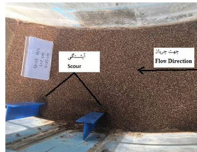
شکل ۲- موقعیت نصب آبشکن T شکل متوالی بعد از آزمایش Fig 2. Scour around the T-shape spur dike of series after testing
