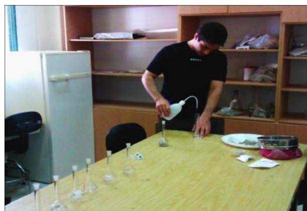
شکل ۸- نمایی از نحوه اندازه‌گیری وزن مخصوص نمونه‌های برداشت شده و نحوه اندازه‌گیری بار معلق
