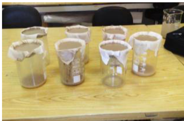
شکل ۸- نمایی از نحوه اندازه‌گیری وزن مخصوص نمونه‌های برداشت شده و نحوه اندازه‌گیری بار معلق
