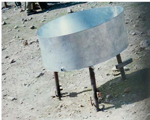
شکل ۳- حوضچه اندازه‌گیری رواناب قبل از نصب Fig 3. Runoff measuring container before installation
