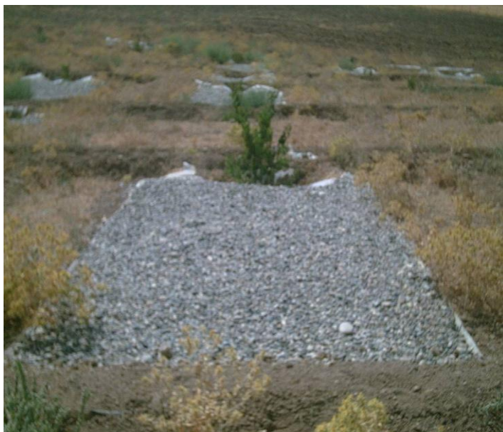
شکل ۲- نمونه‌ای از کرت‌های نیمه‌عایق با پوشش پلاستیک و شن (شکل راست)، شماتیک (شکل چپ)
