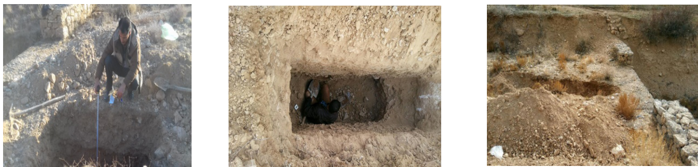
شکل ۲- حفر گودال و نمونه‌گیری از لایه‌های مختلف خاک Fig 2. Pit drill and soil sampling of different layers
