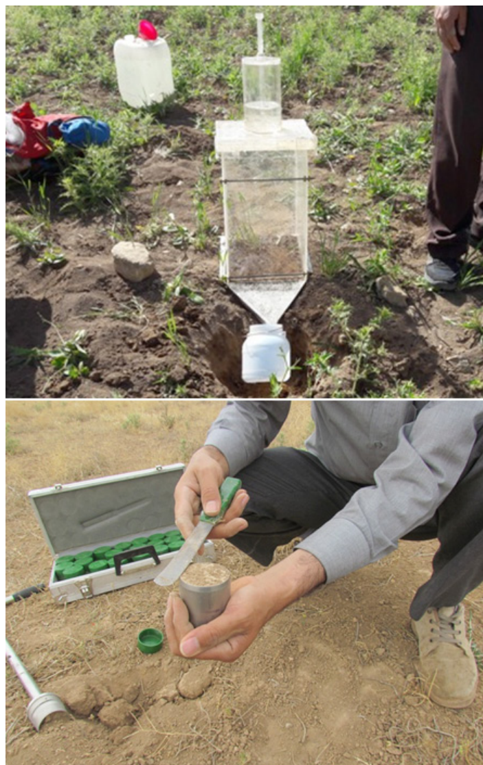
شکل ۲- انجام آزمایش های شبیه ساز باران و نمونه برداری از مزارع آزمایشی Fig 2. Rainfal simulator experiment and soil sampling of selected Farms
