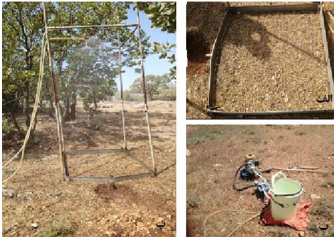
شکل ۲- (الف) کرت آزمایشی، (ب) سیستم آبرسان و (پ) شبیه سازی باران Fig 2. (a) The experimental plot, (b) Irrigation system and (c) Rain simulation
