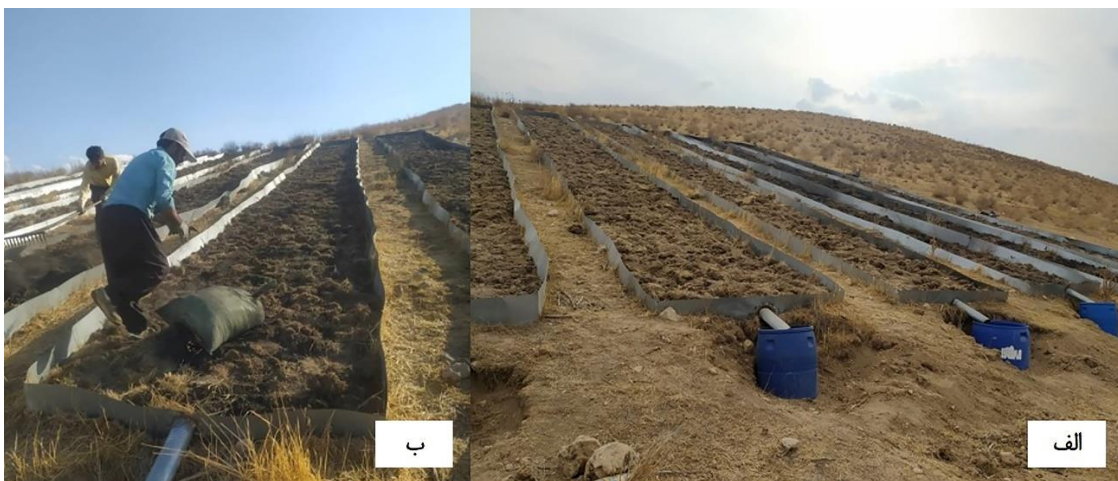
شکل ۲- کرت های استاندارد USLE (الف) و اعمال تیمار حفاظتی در کرت ها (ب) Fig 2. USLE standard plots (a) and application of protection treatment in plots (b)
