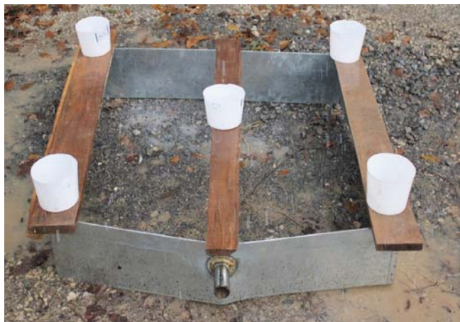
شکل ۳- چیدمان جمع‌آوری‌کننده‌ها برای تعیین شدت و ضریب یکنواختی باران
